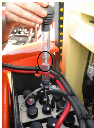
Obrázek 6-8. Měření specifické hmotnosti elektrolytu
